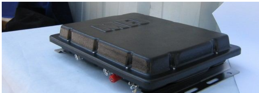
Εξωτερικό antenna tuner ιστού.
