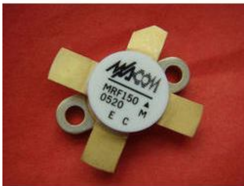
FET Transistor εξόδου ισχύος 150 Watt, τα υψηλά στάσιμα ενδέχεται να το καταστρέψουν.
