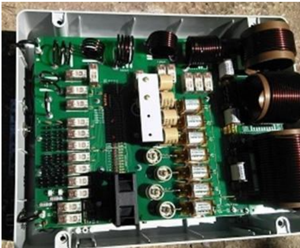
Ένα από τα περίφημα antenna tuner του Στέφανου που συντονίζουν από ένα «κατσαβίδι» έως ένα «μπουγαδόσυρμα» με μηδενικά στάσιμα!
