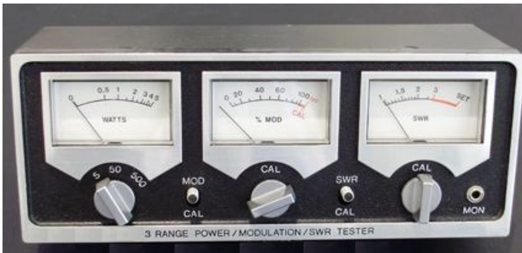
Γέφυρα στασίμων κυμάτων κατάλληλη για μετρήσεις στη Citizen Band αλλά ακατάλληλη για τις Ham Radio Bands
