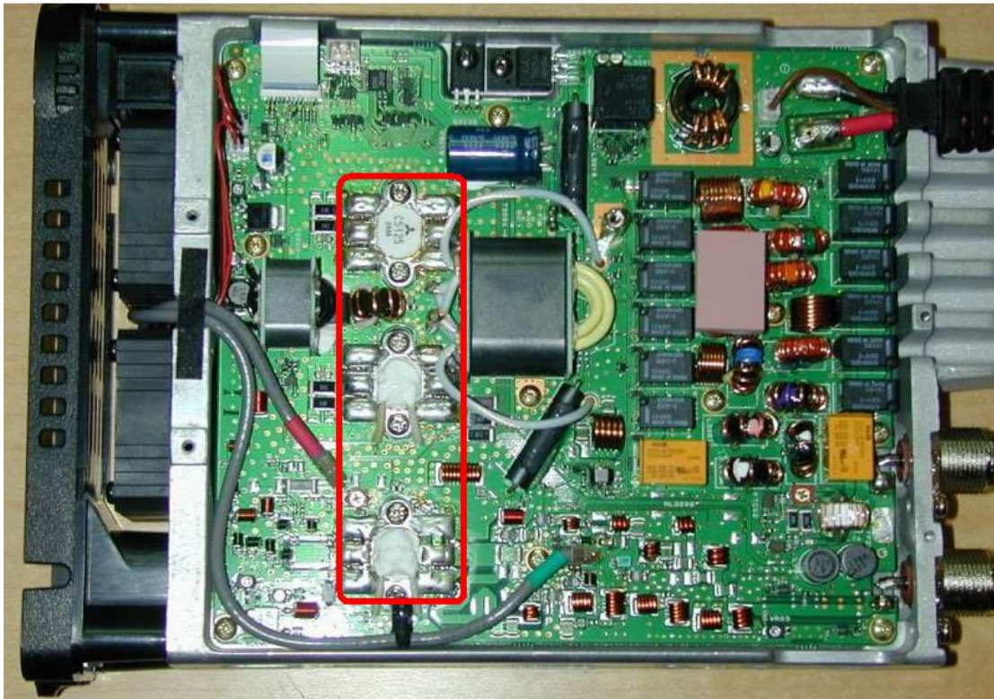
Μέσα στο κόκκινο περιγράμμα φαίνονται τα Final της βαθμίδας εξόδου του πομπού.
