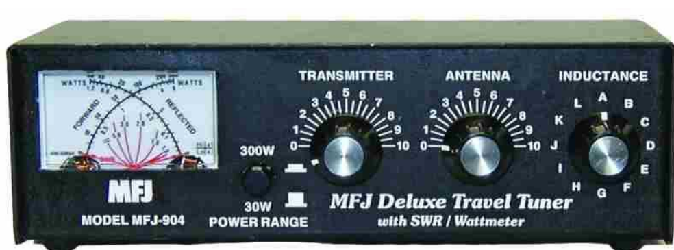
Antenna tuner Βραχέων κυμάτων πχ 3.5-30 MHz
